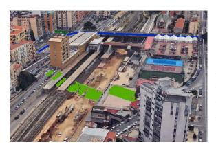
L'opera d'arte più significativa della Tratta B, qui a lato schematicamente ubicata con Google Hearth è manufatto speciale **BM1** che costituisce il nuovo Ponte stradale sulla Stazione Notarbartolo. Esso avrà la funzione di via di fuga in quanto pensato con la funzione di eliminare la situazione di grande criticità veicolare e di inquinamento ambientale attualmente esistente davanti la Stazione Notarbartolo.
