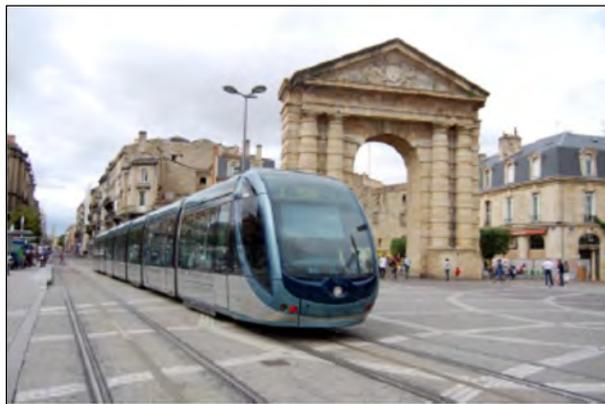
Questo sistema di captazione da terra permette stesse performance del sistema con catenaria aerea, la stessa potenza disponibile, analoghe accelerazioni, velocità massima, pendenze superabili fino all'8%, nessun impatto sui tempi di sosta nelle fermate e capolinea ed infine, stessa “vita utile attesa”.
