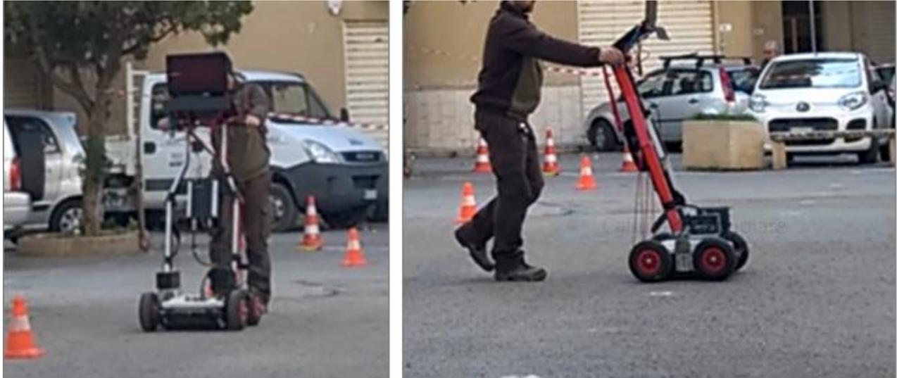
**Foto nn. 7.1 e 7.2:** Esecuzione di scansioni georadar con antenna multifrequenza 200 Mhz e 600 MHz
