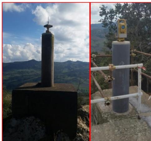
**Figura 5** - Esempio di materializzazione dei caposaldi per lo stazionamento della strumentazione.
