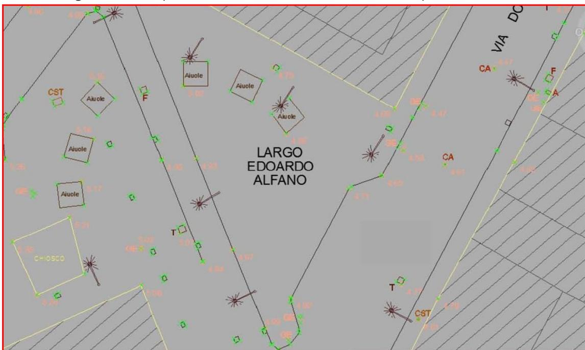
**Figura 8 – Dettaglio sulla restituzione grafica del rilievo topografico.**
