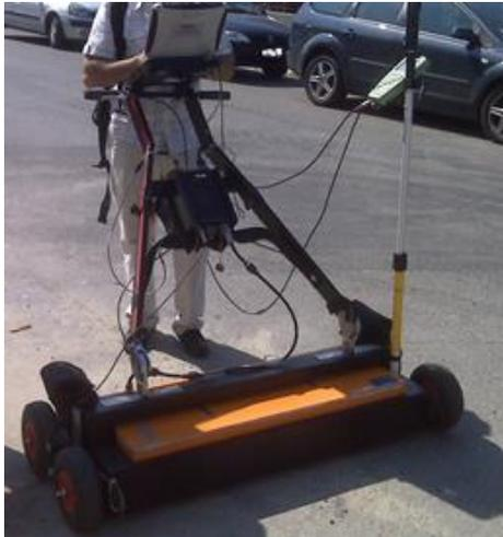
**Foto 7.3:** sistema GPR con antenna multiarray interfacciata ad un GPS topografico.
