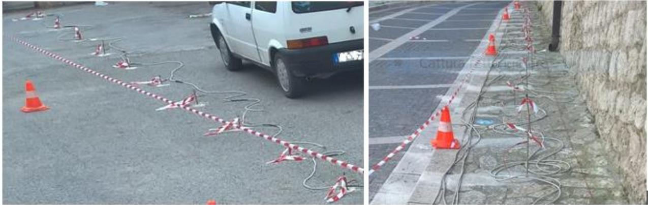
**Foto 7.5 e 7.6:** Esecuzione di tomografia elettrica 3D con elettrodi infissi sulla pavimentazione stradale o sui marciapiedi per non intralciare la circolazione veicolare.
