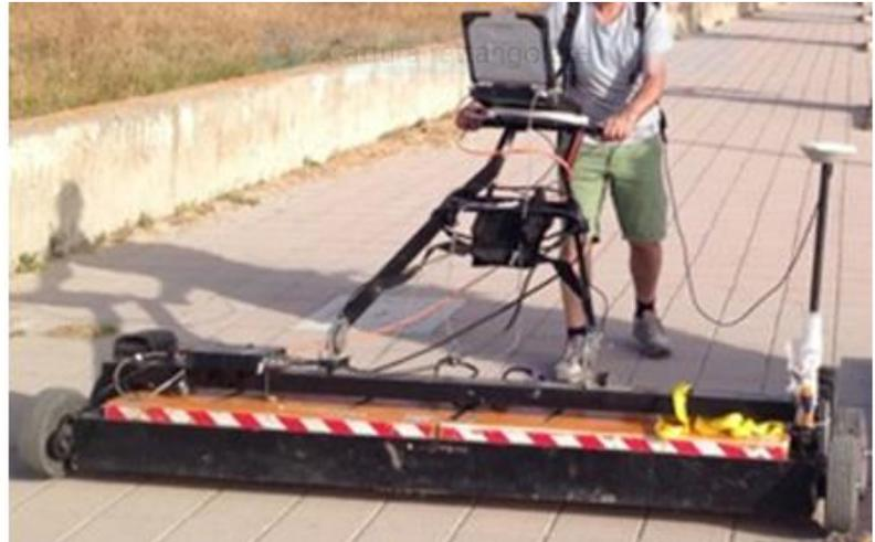
**Foto 7.4:** sistema GPR costituito da due antenne multiarray affiancate ed interfacciate ad un GPS topografico.
