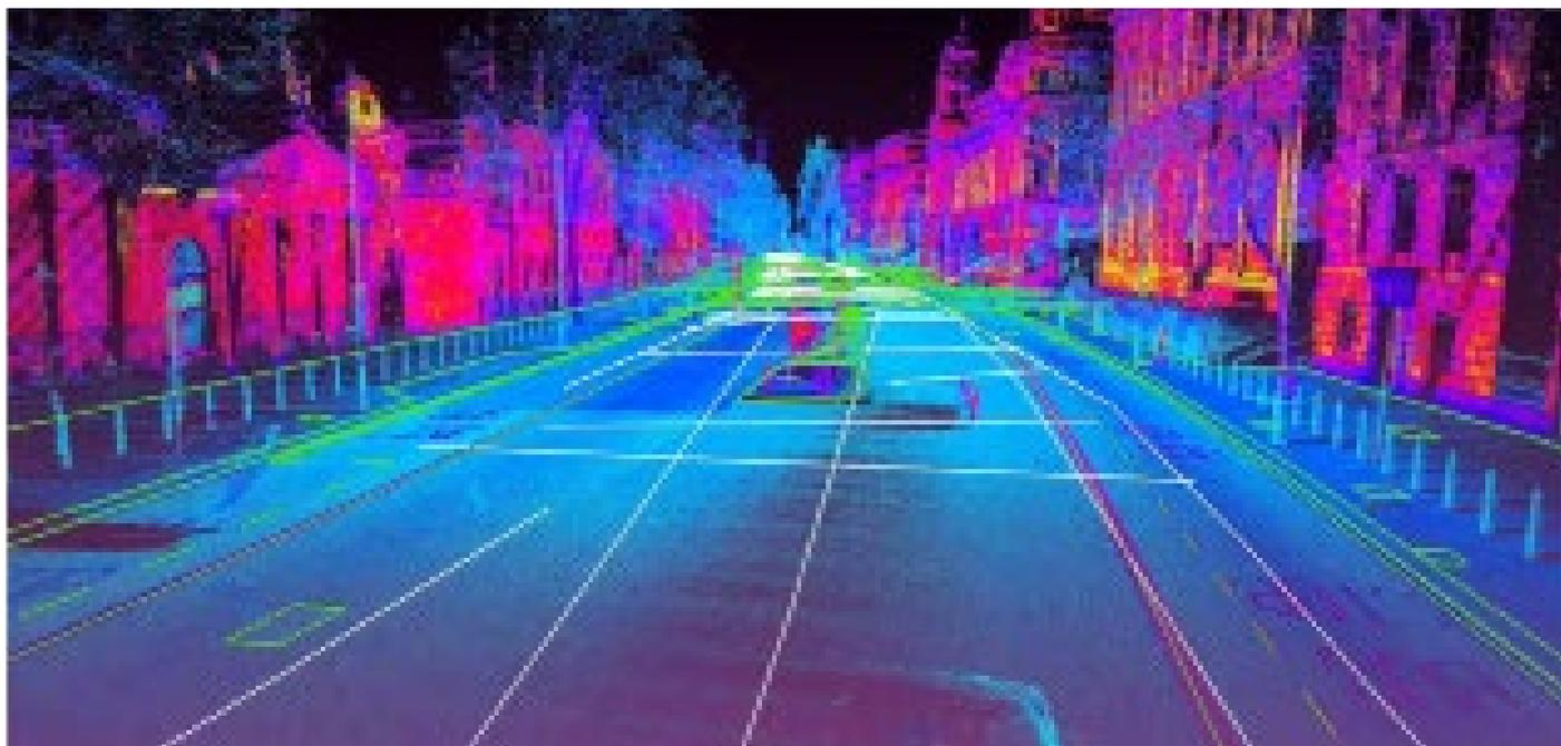
*Esempio di nuvola di punti acquisita con tecnica Mobile Mapping Laser Scanner*
